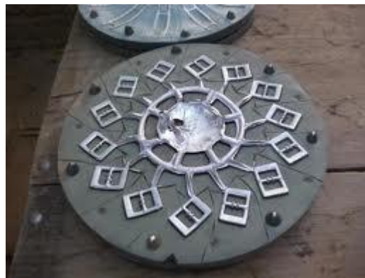
Figura 33: Equipo completo para la fundición centrífuga.
