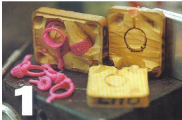
Figura 3: Ejemplo del molde a la cera perdida.
