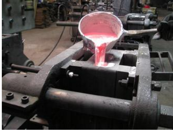
Figura 24: Colada de metal en coquilla.
