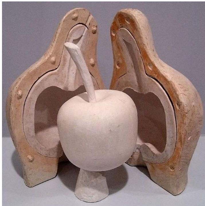
Figura 1. Molde (las dos mitades exteriores) y modelo (manzana hecha de madera).
