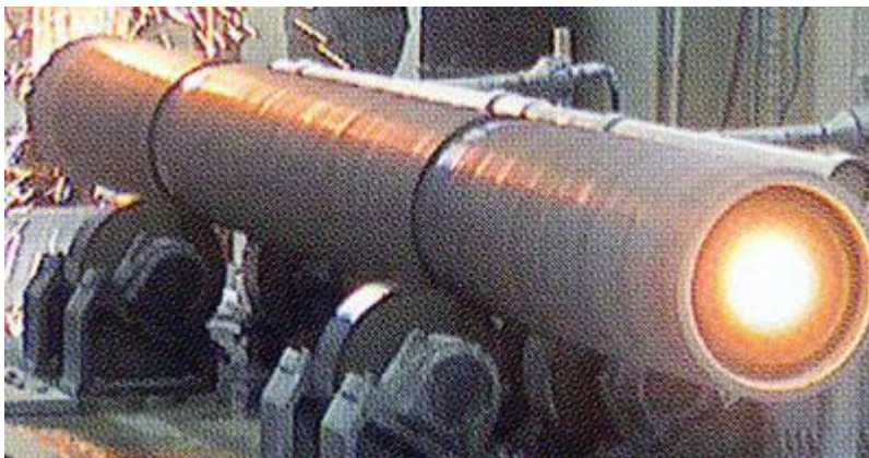
Figura 32: Fabricación de tubos por fundición centrífuga.
