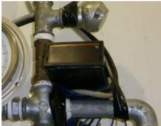
**Figura 3.22:** Termómetro electrónico
