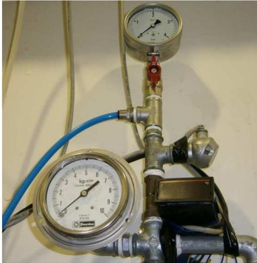
**Figura 3.3:** Manómetro de mayor rango (abajo) y manómetro de menor rango (arriba)
