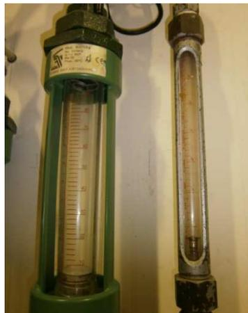
**Figura 3.2:** Rotámetros de aire montados en paralelo.
