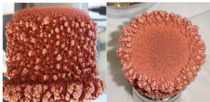
Figura 43: Pieza de cobre electroformado obtenido a 4 A/dm<sup>2</sup> con velocidad de giro de 4 rev/s tras 42 h de proceso de electrodeposición a corriente continua.
