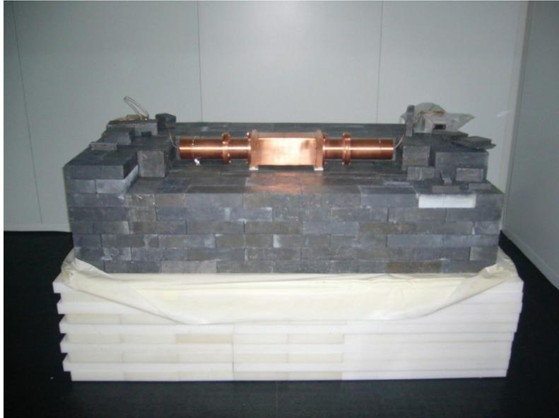
Figura 5: Progreso de montaje del blindaje del Prototipo IV. Sobre el plomo se ve el detector con su carcasa de cobre. En el centro el cristal con forma paralelepédica y en los extremos los fotomultiplicadores en sus carcasas de forma cilíndrica.
