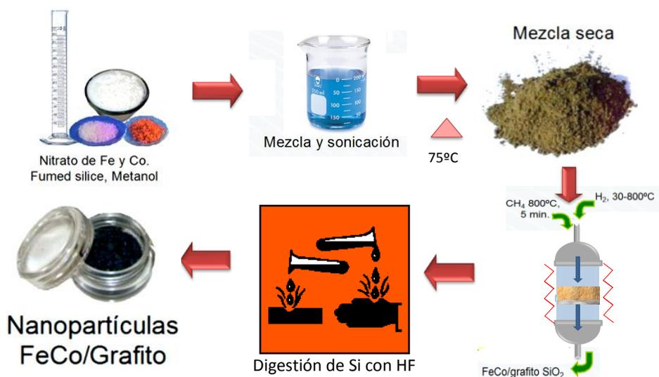
Figura 2.5. Esquema de procedimiento de síntesis de nanopartículas de FeCo/G.
