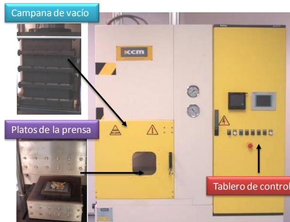
Figura 2.11. Prensa uniaxial isotérmica utilizado en el procesado de nanocompuestos.
