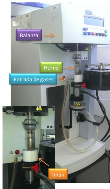
*Figura 2.21. Equipo de análisis termogravimétrico en configuración para medidas de termogravimetría magnética.*
