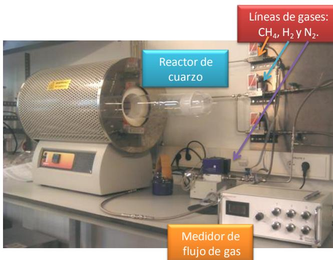
Figura 2.7. Montaje experimental de la síntesis de nanopartículas de  $FeCo/G_{escalado2}$ .
