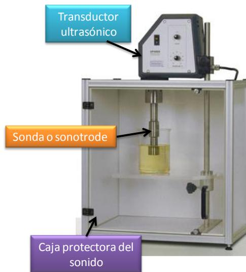
Figura 2.8. Equipo de sonicación utilizado en el procesado de nanocompuestos.
