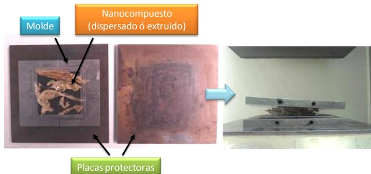
Figura 2.12. Molde usado con la prensa uniaxial isotérmica para el procesado de nanocompuestos.
