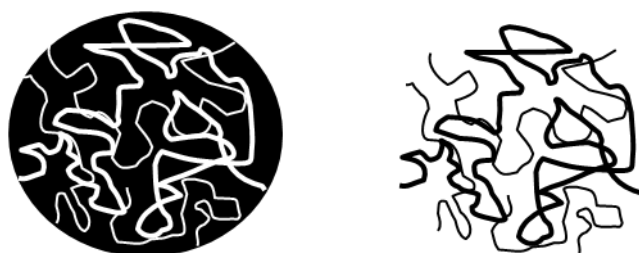
Figura 4.1: Representación de un soporte inorgánico convencional (izqda.) y de un agregado de nanofibras de carbono (decha.)
