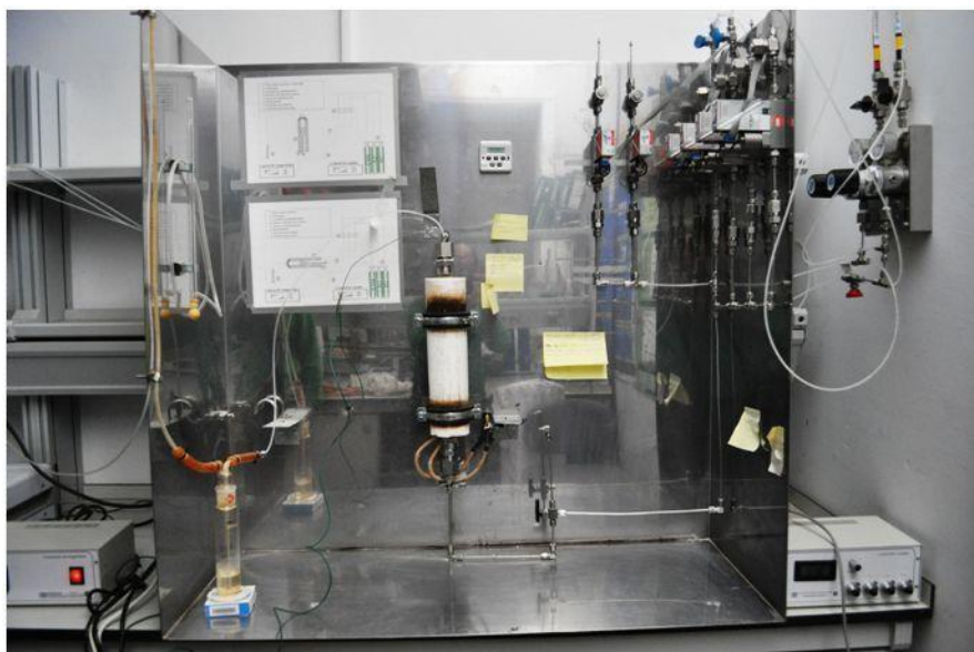
Figura 2.4: Montaje experimental en donde fueron llevados a cabo los ensayos catalíticos.
