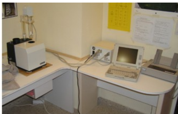
Fig. 13.-Fotografía del equipo utilizado para la medida de la ASM (kly3-s)
