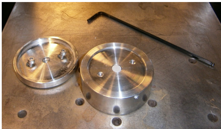
Figura 20. Vista de la muestra de material en el interior del utillaje empleado en un ensayo de compresión confinada.
