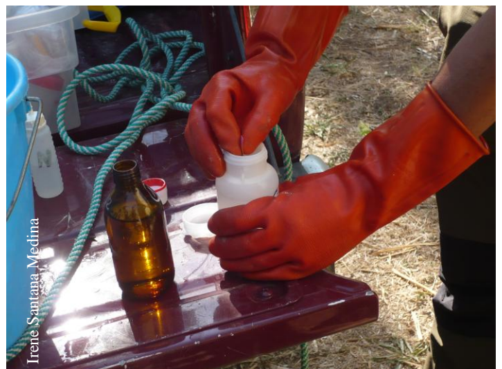
Figura 17. Introducción de banda colorimétrica después del reactivo. La banda cambia de color según el valor del pH.
