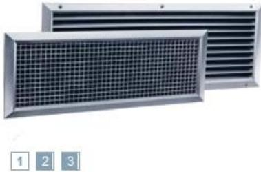
Rejillas para retorno preferentemente en pared y conducto, formadas por un marco frontal con lamas horizontales o inclinadas, o bien lamas nervadas fijas, montaje en obra a elección con o sin marco de montaje, mediante fijación oculta, tornillos de sujeción vistos, o mediante muelles.
