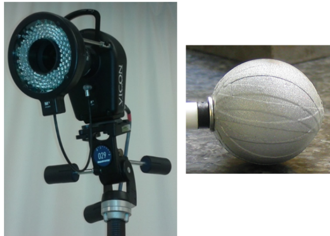
Figura 2.1: Cámara VICON y marcador pasivo retro-reflectante.
