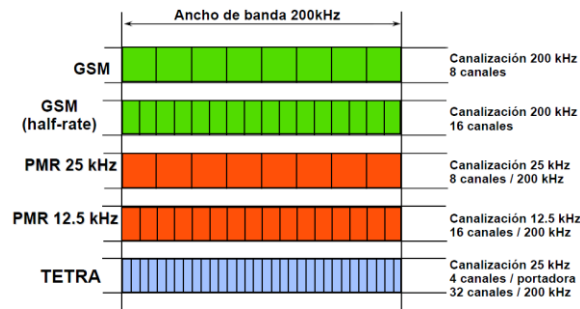
Imagen 4.- Comparativa de canales GSM / PMR / TETRA
