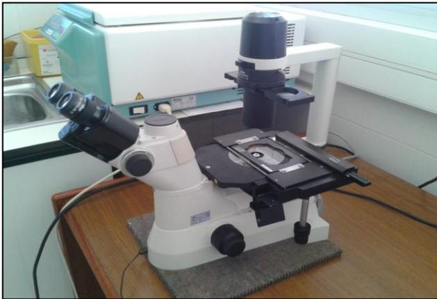
Figura 13: Microscopio invertido.
