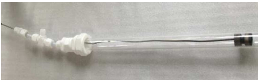
Figura AIII.2 Imagen del monolito de carbono fijado dentro del tubo de cuarzo mediante unas piezas de porcelana
