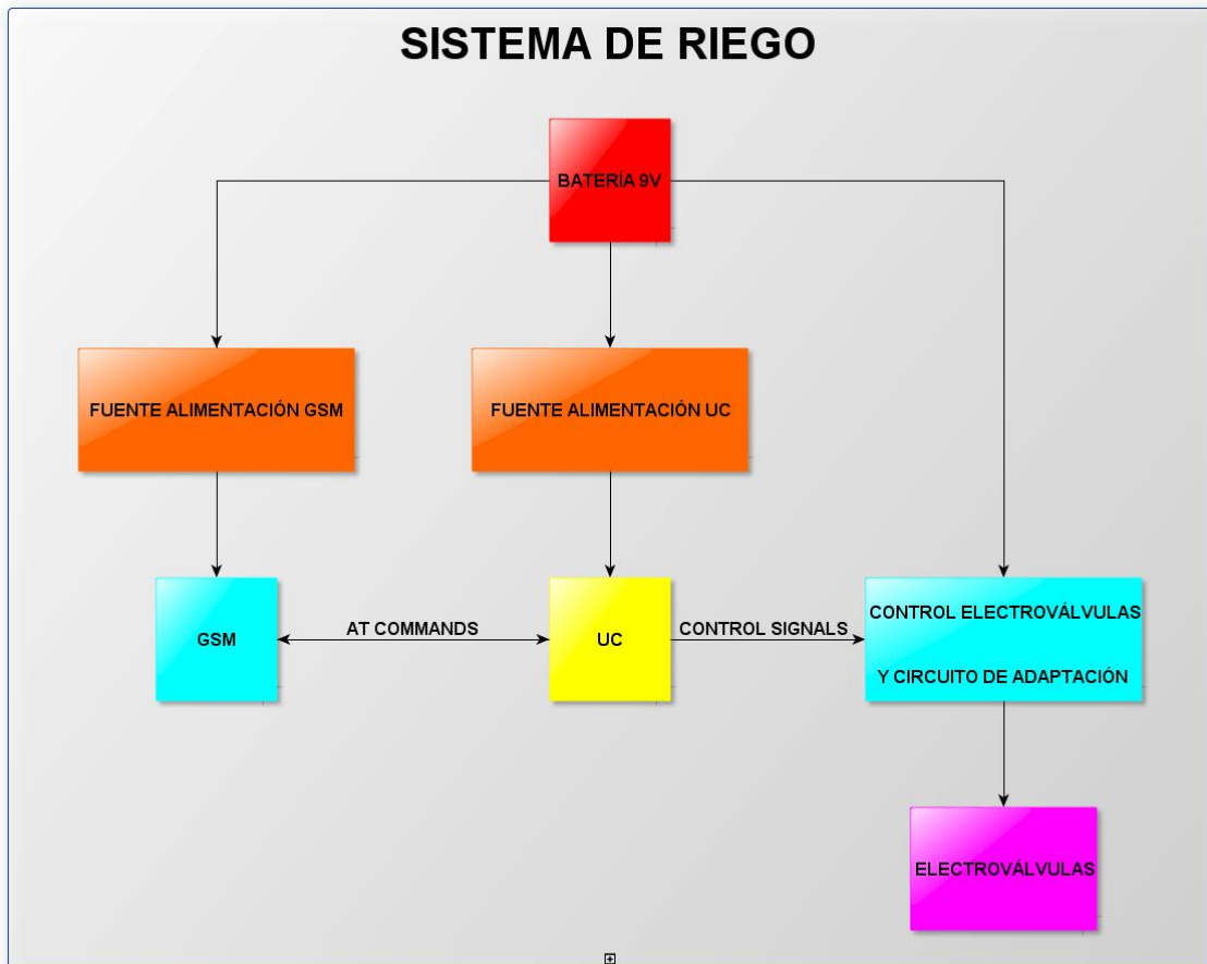
Ilustración 3: DIAGRAMA DE BLOQUES SISTEMA FINAL
