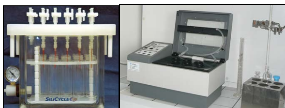
Figura 42. Equipos empleados en el proceso de extracción: Vacuum Manifold (izquierda); TurboVap (derecha).
