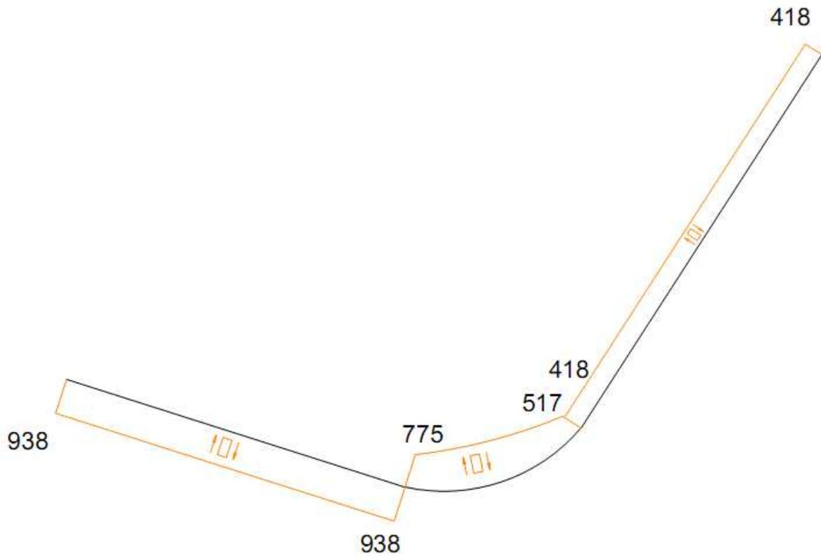
Figura 57: Diagrama esfuerzos Cortantes pedal (N)
