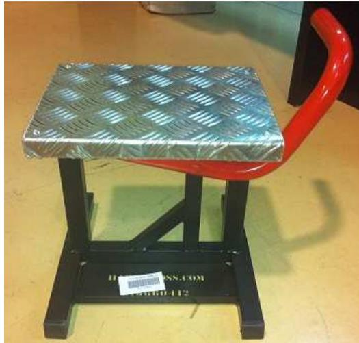
Figura 11: Caballete de doble pilar con apoyo reforzado
