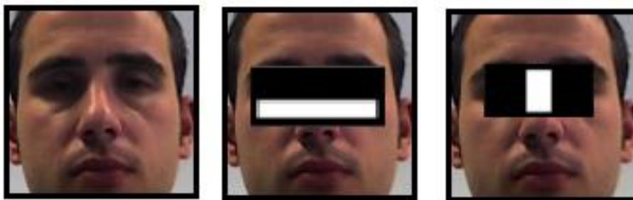
Figura G1. Patrones en forma de dos o tres rectángulos respectivamente reconocibles para un rostro humano
