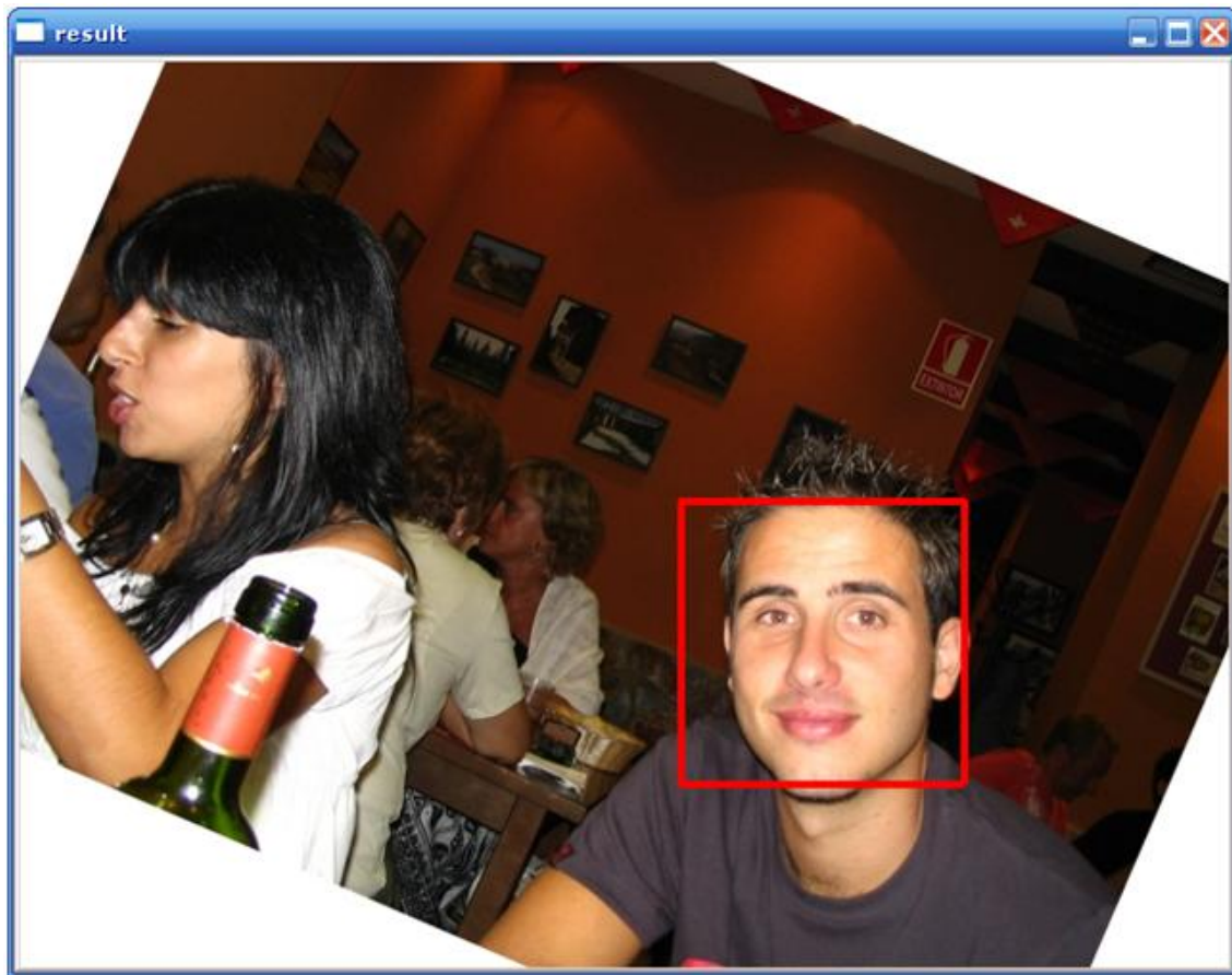
Figura G6. Captura de pantalla con la imagen resultado de la prueba de detección de caras sobre la foto 4b.
