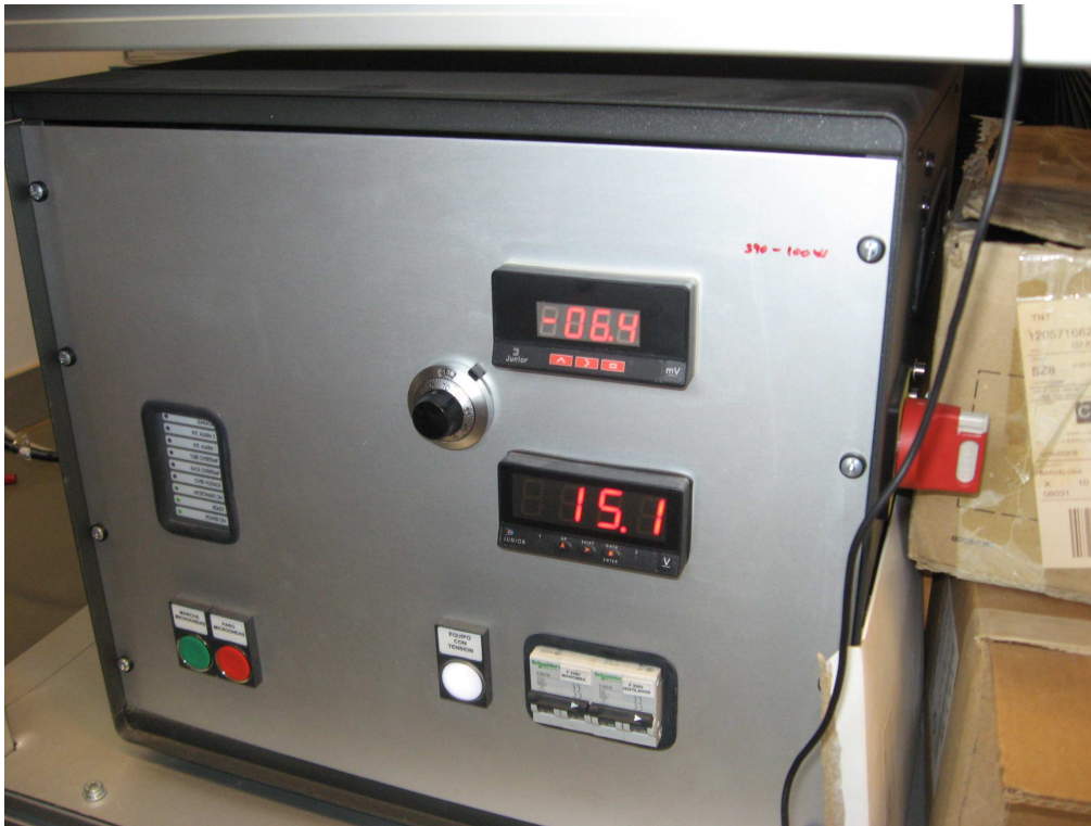
Figura 5-4 Regulador manual de potencia y pantallas de onda generada y reflejada.
