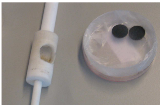
Figura 5-2 Muestra, reactor de teflón y pastillas de catalizador.
