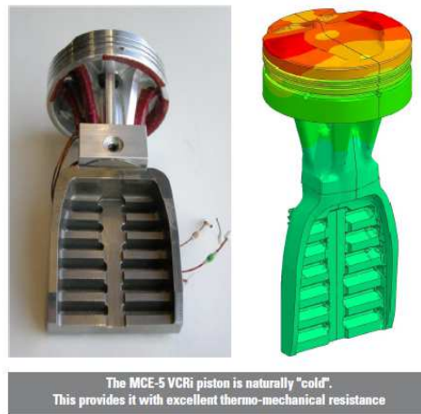
Imagen 112. Estado térmico del pistón en funcionamiento
