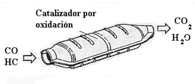
Imagen 126. Catalizador por oxidación
