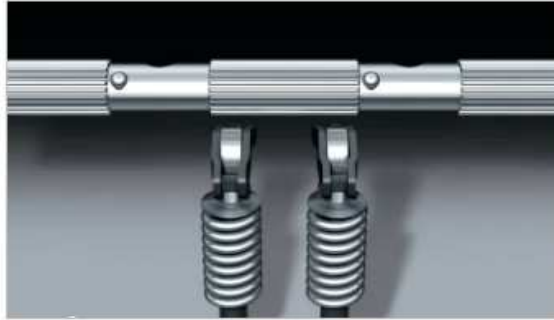
Imagen 77. Eje ranurado sobre el que se coloca la pieza flotante
