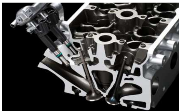
Imagen 41. Sistema de inyección Dual
