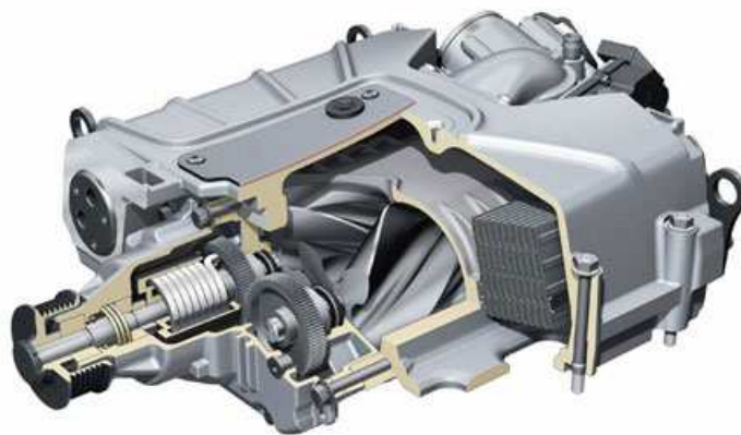
3,0 Liter-V6-TFSI-Motor Auflademodul 3.0 litre V6 TFSI engine Supercharger module 02/09
