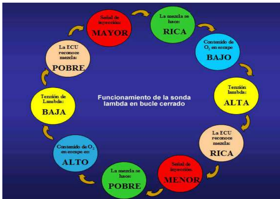
Imagen 151. Funcionamiento de la sonda en bucle cerrado
