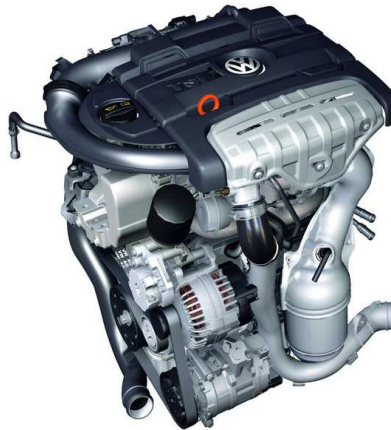
Imagen 191. Motor 1.4 TSI de VW
