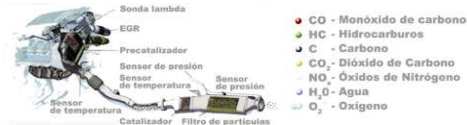
Imagen 138. Línea de escape con post-tratamiento
