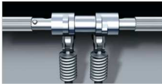
Imagen 78. Pieza flotante encajada axialmente con el eje
