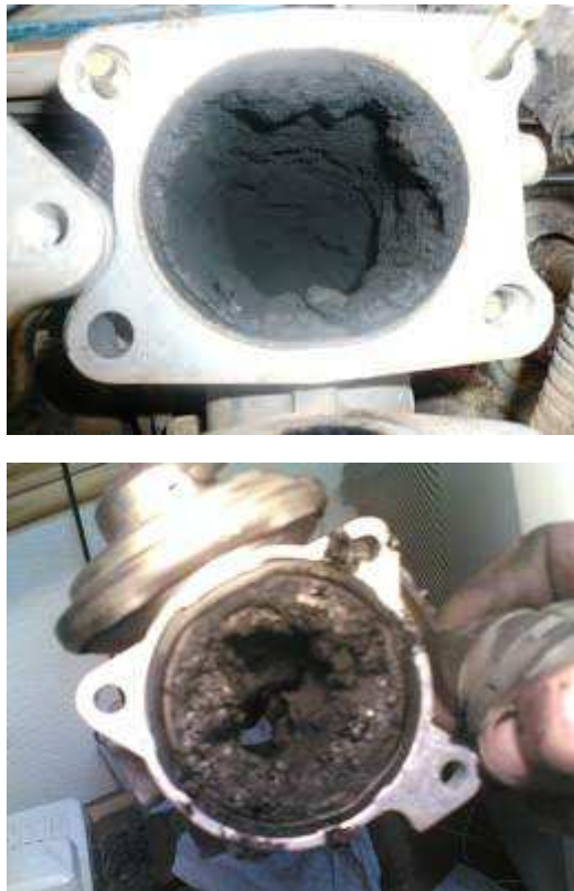
Imagen 171. Carbonilla acumulada en la válvula EGR
