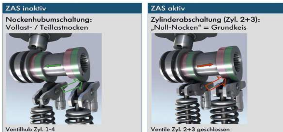
Imagen 76. Desplazamiento axial de la pieza flotante cambiando el perfil de leva en contacto
