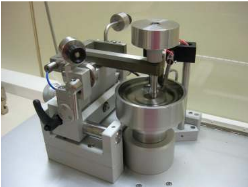
Figura 19. Imagen del tribómetro durante un ensayo
