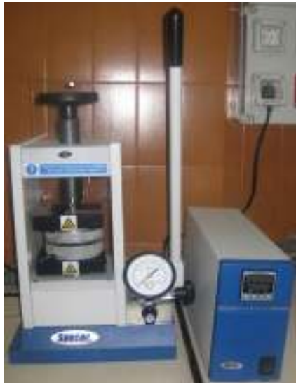
Figura 15. Prensa hidráulica y placas calefactoras utilizadas en el proceso de conformado por moldeo.
