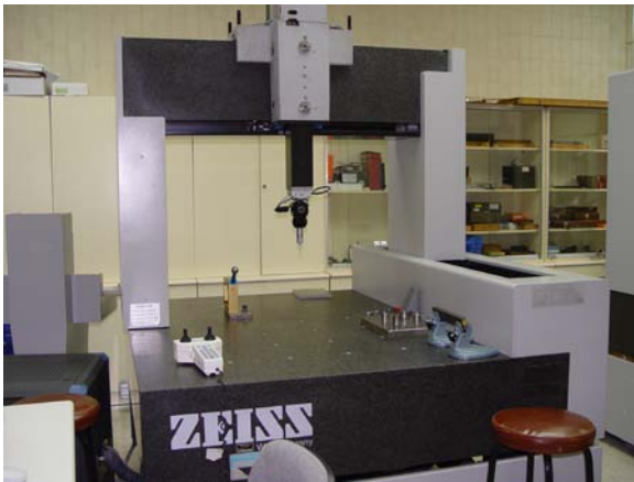
Fig. 58: máquina de medición por coordenadas, apta para la caracterización de los flexos (Laboratorio de Metrología del Departamento de Ingeniería de Diseño y Fabricación)
