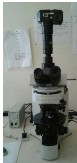
Fig. 8: Microscopio doble, de luz reflejada y transmitida con cámara fotográfica incorporada. Área de Cristalografía y Mineralogía, Universidad de Zaragoza.
