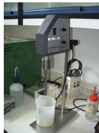
Figura 3.1: Ultrasonador UP-200 utilizado para la rotura de las células recogidas.
