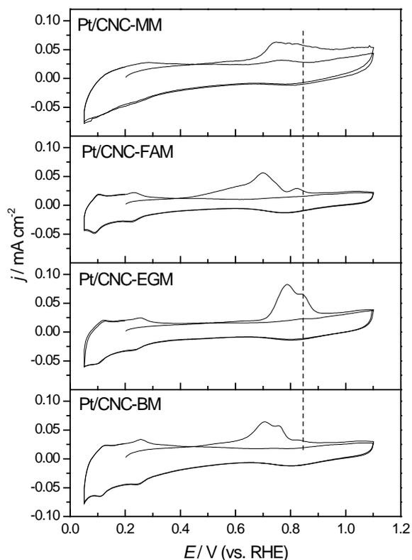
**Figura 3.10.** Oxidación de una monocapa de CO para los catalizadores Pt/CNC preparados en  $0.5\text{ M H}_2\text{SO}_4$ .  $E_{ad} = 0.20\text{ V}$ ;  $v = 0.020\text{ V s}^{-1}$ ;  $T = 25\text{ }^\circ\text{C}$ .
