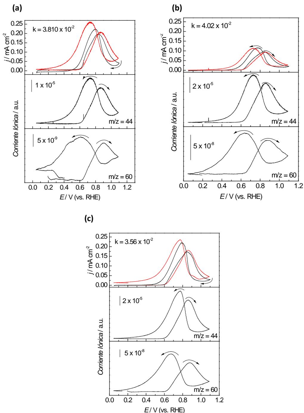
**Figura 3.18.** VCs y VCEMs para la oxidación de metanol 0.5 M en  $\text{H}_2\text{SO}_4$  0.5 M para los electrodos Pt/CNC-BM (a), Pt/Vulcan-FAM (b) y Pt/C E-TEK (c).  $v = 0.001 \text{ V s}^{-1}$ ;  $T = 25 \text{ }^\circ\text{C}$ .
