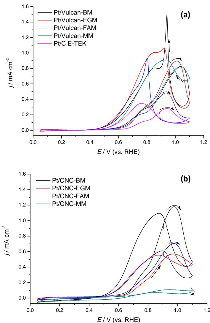
**Figura 3.14.** Voltamogramas cíclicos de los electrocatalizadores de Pt/Vulcan (a) y Pt/CNC (b) en una solución 2 M  $\text{CH}_3\text{OH}$  + 0.5 M  $\text{H}_2\text{SO}_4$ .  $v = 0.02 \text{ V s}^{-1}$ ;  $T = 25 \text{ }^\circ\text{C}$ .
