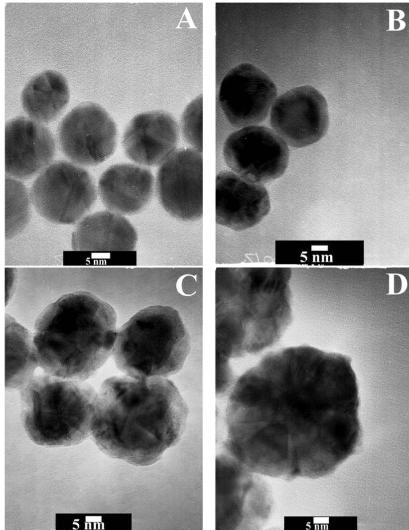
**Figura 3.25.** Imágenes HRTEM de las nanopartículas core-shell con núcleos de Au de diámetro  $19.3 \pm 1.2$  nm, recubiertos de capas de Pd de espesores  $1.3 \pm 0.09$  nm (A),  $2.7 \pm 0.1$  nm (B),  $5.1 \pm 0.9$  nm (C) y  $9.9 \pm 1.0$  nm (D), respectivamente [MONTES DE OCA 2012].
