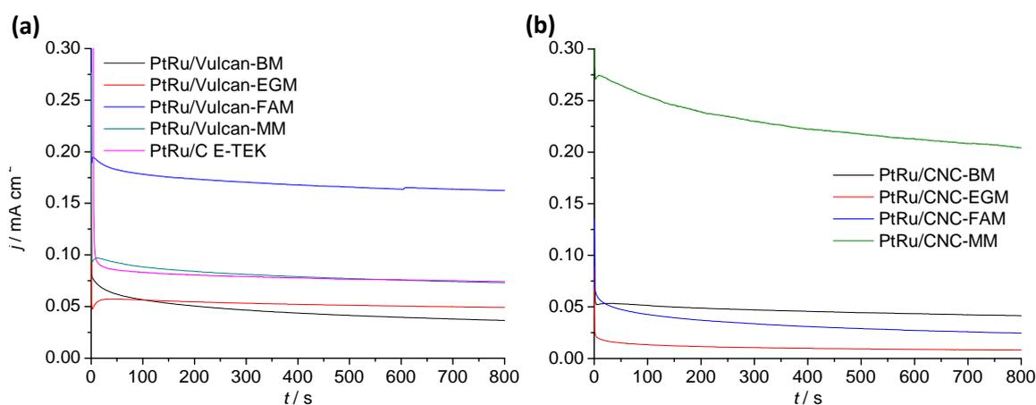
**Figura 3.17.** Curvas cronoamperométricas para los catalizadores PtRu/Vulcan (a) y PtRu/CNC (b) registrada en  $2\text{ M CH}_3\text{OH} + 0.5\text{ M H}_2\text{SO}_4$  a  $E = 0.60\text{ V}$  y temperatura ambiente.
