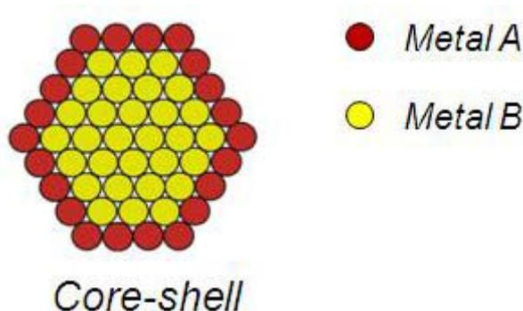
**Figura 1.4.** Representación esquemática de la estructura *core-shell*.
