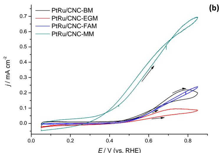
**Figura 3.15.** Voltagramas cíclicos de los electrocatalizadores de Pt-Ru/Vulcan (a) y PtRu/CNC (b) en una solución 2 M  $CH_3OH$ + 0.5 M  $H_2SO_4$ .  $v = 0.02 V s^{-1}$ ;  $T = 25 ^\circ C$ .
