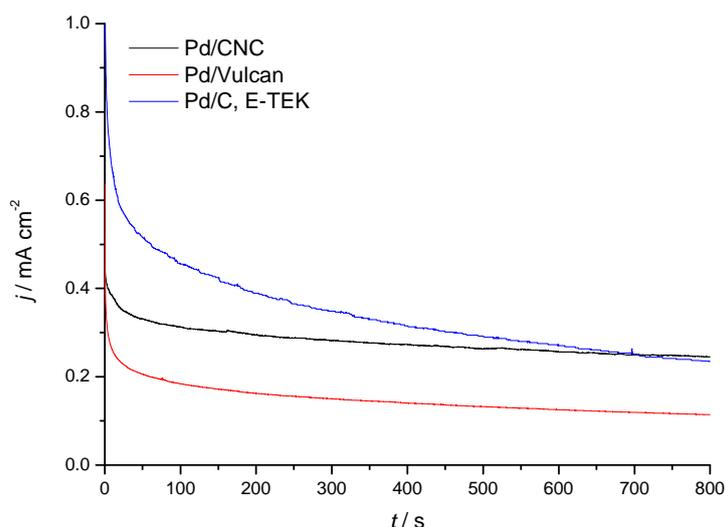
**Figura 3.24.** Curvas cronoamperométricas para los catalizadores de Pd/C, registradas en 2 M HCOOH + 0.5 M H<sub>2</sub>SO<sub>4</sub> a E = 0.60 V y temperatura ambiente.
