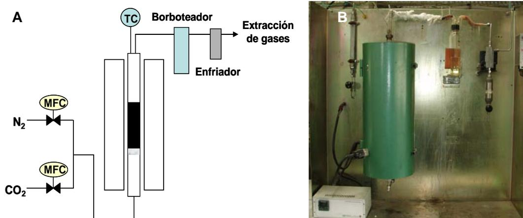
**Figura 2.1.** Instalación de carbonización. A) Esquema; B) Fotografía.
