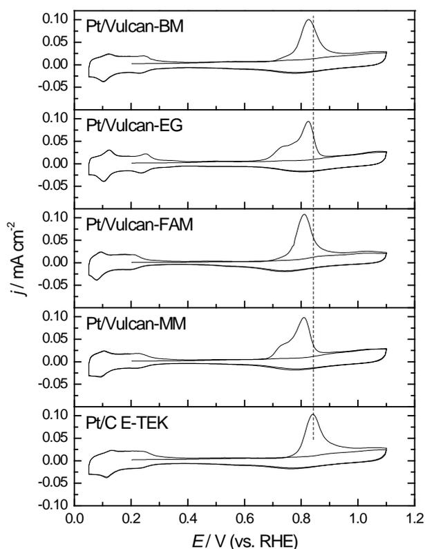
**Figura 3.9.** Oxidación de una monocapa de CO para los catalizadores Pt/Vulcan preparados y del catalizador comercial Pt/C de E-TEK en  $0.5\text{ M H}_2\text{SO}_4$ .  $E_{ad} = 0.20\text{ V}$ ;  $v = 0.020\text{ V s}^{-1}$ ;  $T = 25\text{ }^\circ\text{C}$ .
