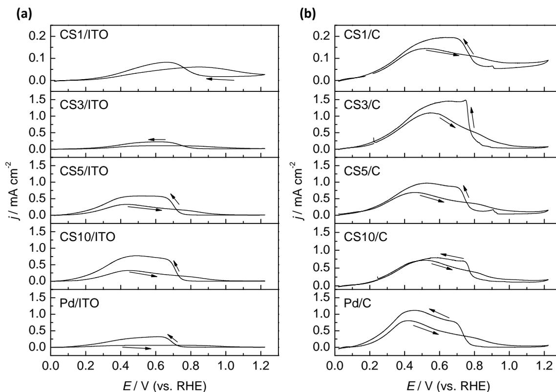
**Figure 3.30.** Voltamogramas cíclicos de las nanopartículas de Pd y core-shell ensambladas en ITO (a) y soportadas en Vulcan (b), a  $0.02 \text{ V s}^{-1}$ , en una solución  $2 \text{ M HCOOH} + 0.5 \text{ M H}_2\text{SO}_4$ .
