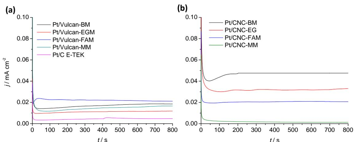
**Figure 3.21.** Curvas cronoamperométricas para los electrocatalizadores Pt/Vulcan (a) y Pt/CNC (b) registradas en 2 M  $\text{CH}_3\text{CH}_2\text{OH}$  + 0.5 M  $\text{H}_2\text{SO}_4$  a  $E = 0.60$  V y temperatura ambiente.
