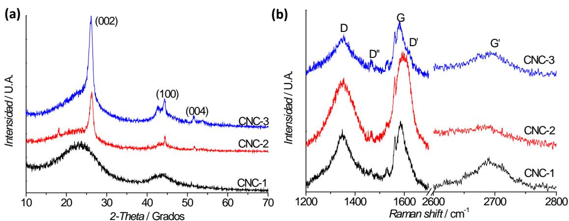
**Figura 3.3.** Difractogramas XRD (a) y espectros Raman de primer y segundo orden (b) de las CNC.
