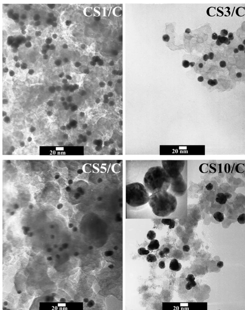
**Figura 3.26.** Imágenes TEM de las distintas nanoestructuras CS soportadas en Vulcan. La inserción en la muestra CS10 es una imagen a mayor aumento que muestra el contraste entre el corazón de Au y las capas de Pd [CELORRIO 2012].
