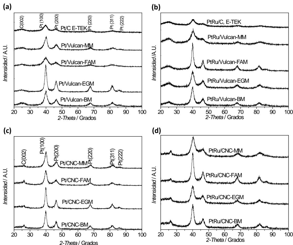
**Figura 3.5.** Difractogramas XRD de los electrocatalizadores *Pt/Vulcan* (a), *Pt-Ru/Vulcan* (b), *Pt/CNC* (c) y *Pt-Ru/CNC* (d).
