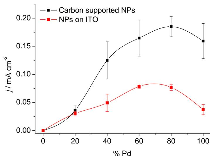
**Figure 3.31.** Densidades de corriente después de 750 s asociadas con la oxidación de HCOOH a 0.60 V (vs. RHE) en las distintas nanoestructuras ensambladas en ITO (línea roja) y soportadas en Vulcan (línea negra) en 0.5 M H<sub>2</sub>SO<sub>4</sub> + 2M HCOOH.
