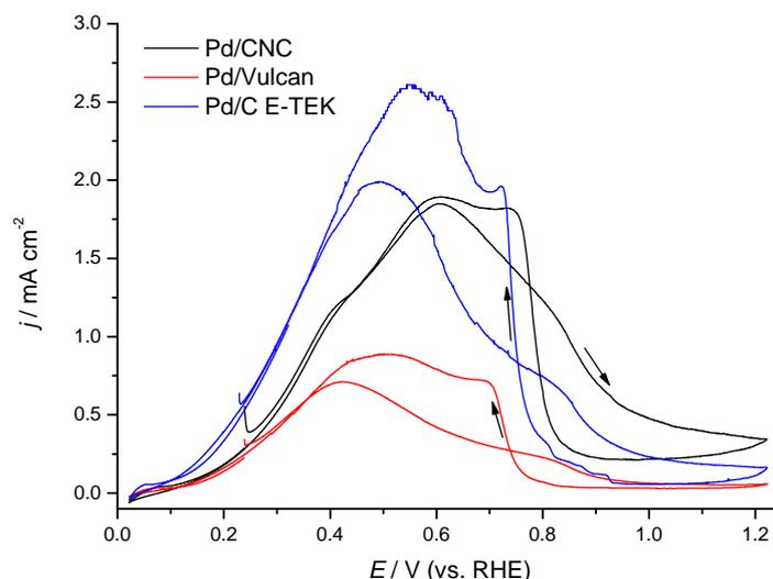
**Figura 3.23.** Voltagramas cíclicos para los catalizadores Pd/CNC, Pd/Vulcan y Pd/C de E-TEK en  $2 \text{ M HCOOH} + 0.5 \text{ M H}_2\text{SO}_4$ ,  $v = 0.020 \text{ V s}^{-1}$ ;  $T = 25 \text{ }^\circ\text{C}$ .
