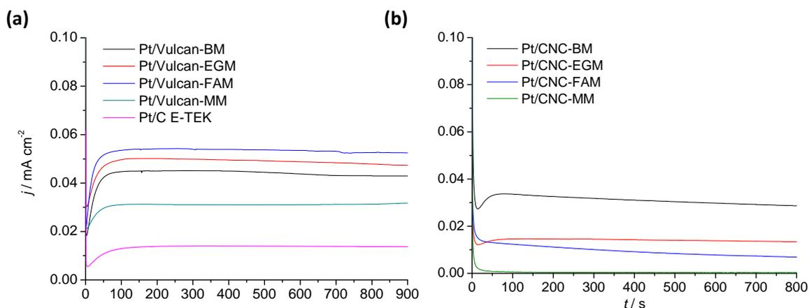
**Figura 3.16.** Curvas cronoamperométricas para los catalizadores Pt/Vulcan (a) y Pt/CNC (b) registrada en  $2\text{ M CH}_3\text{OH} + 0.5\text{ M H}_2\text{SO}_4$  a  $E = 0.60\text{ V}$  y temperatura ambiente.
