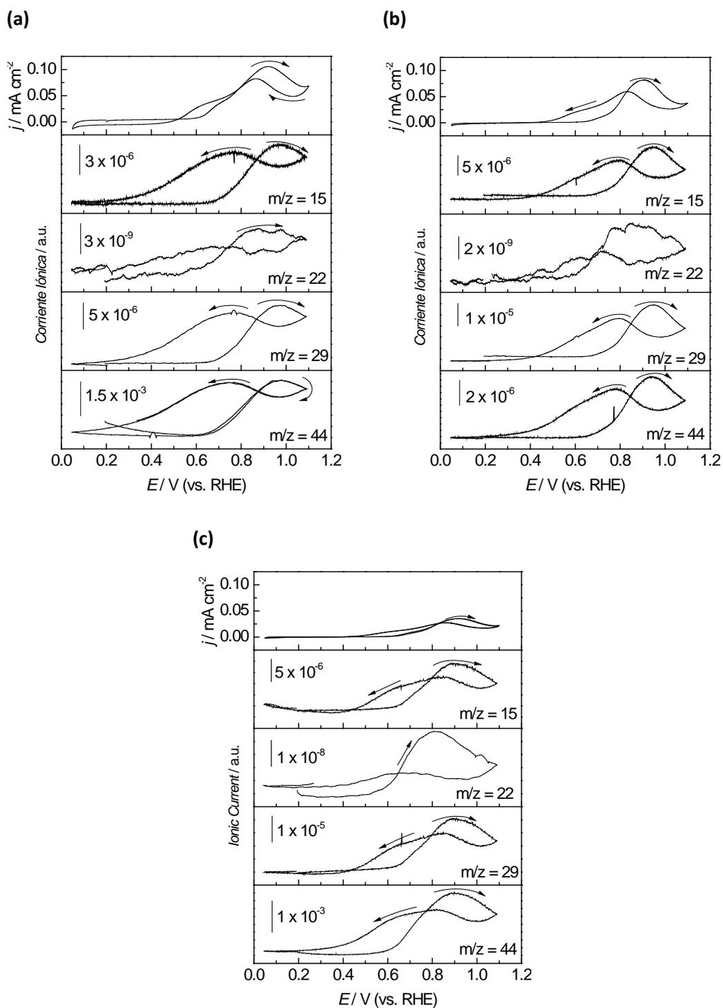
**Figura 3.22.** VCs y VCEMs para la oxidación de etanol 0.5 M en  $H_2SO_4$  0.5 M en los electrocatalizadores Pt/CNC-BM (a), Pt/Vulcan-FAM (b) y Pt/C E-TEK (c).  $v = 0.001 \text{ V s}^{-1}$ ;  $T = 25 \text{ }^\circ\text{C}$ .
