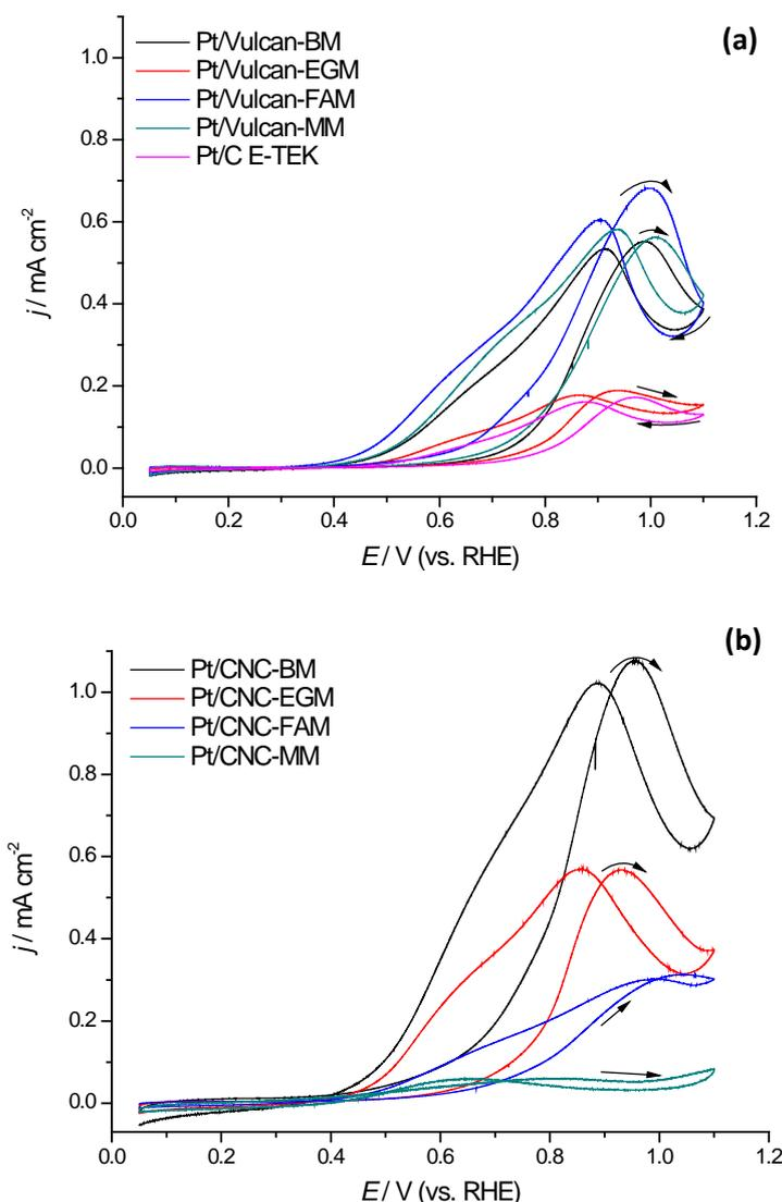
**Figura 3.20.** Voltagramas cíclicos de los electrocatalizadores de Pt/Vulcan (a) y Pt/CNC (b) en una solución  $2\text{ M CH}_3\text{CH}_2\text{OH} + 0.5\text{ M H}_2\text{SO}_4$ .  $v = 0.02\text{ V s}^{-1}$ ;  $T = 25\text{ }^\circ\text{C}$ .
