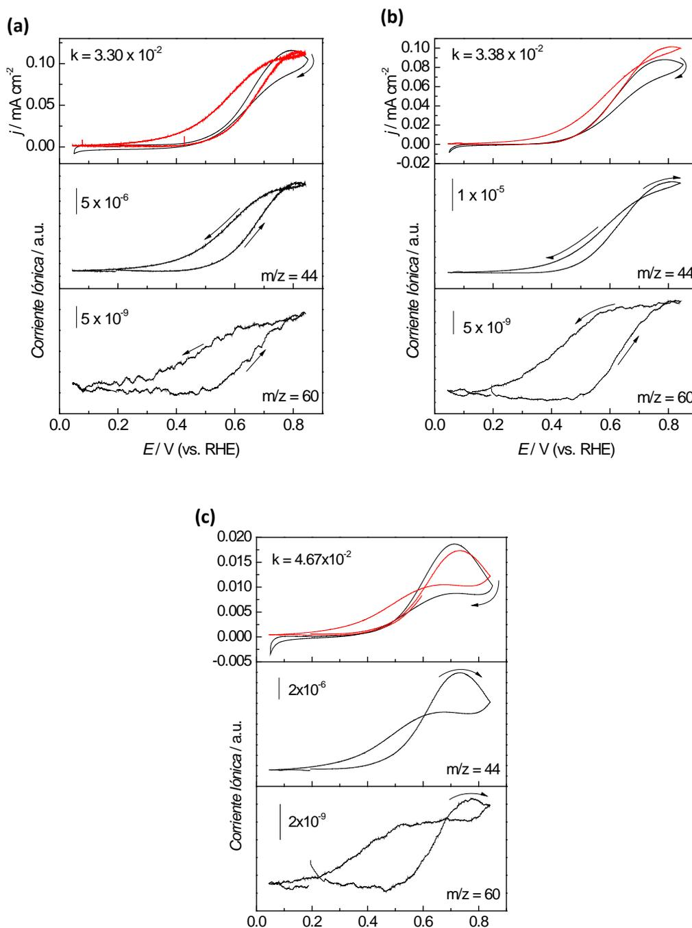
**Figure 3.19.** CVs y VCEMs para la oxidación de metanol 0.5 M en  $\text{H}_2\text{SO}_4$  0.5 M en los electrodos PtRu/CNC-MM (a), PtRu/Vulcan-FAM (b) y PtRu/C E-TEK (c).  $v = 0.001 \text{ V s}^{-1}$ ;  $T = 25 \text{ }^\circ\text{C}$ .
