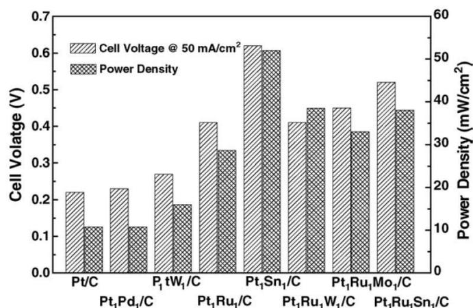
**Figura 1.6.** Efecto de la adición de distintos metales a la actividad del platino en la oxidación de etanol medidas en una monocelda PEMFC alimentada con etanol en las mismas condiciones de operación [SONG 2006].
