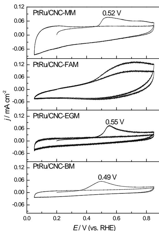
**Figura 3.12.** Oxidación de una monocapa de CO adsorbido sobre los catalizadores PtRu/CNC en  $0.5\text{ M H}_2\text{SO}_4$ .  $E_{ad} = 0.20\text{ V}$ ;  $v = 0.020\text{ V s}^{-1}$ ;  $T = 25\text{ }^\circ\text{C}$ .
