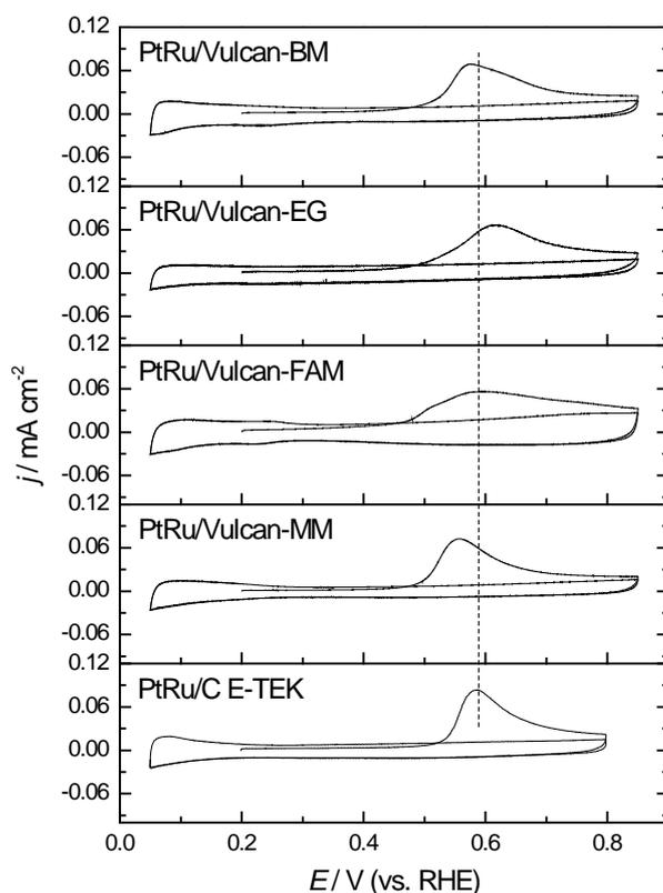
**Figura 3.11.** Oxidación de una monocapa de CO adsorbida sobre los catalizadores PtRu/Vulcan en  $0.5\text{ M H}_2\text{SO}_4$ .  $E_{ad} = 0.20\text{ V}$ ;  $v = 0.020\text{ V s}^{-1}$ ;  $T = 25\text{ }^\circ\text{C}$ .
