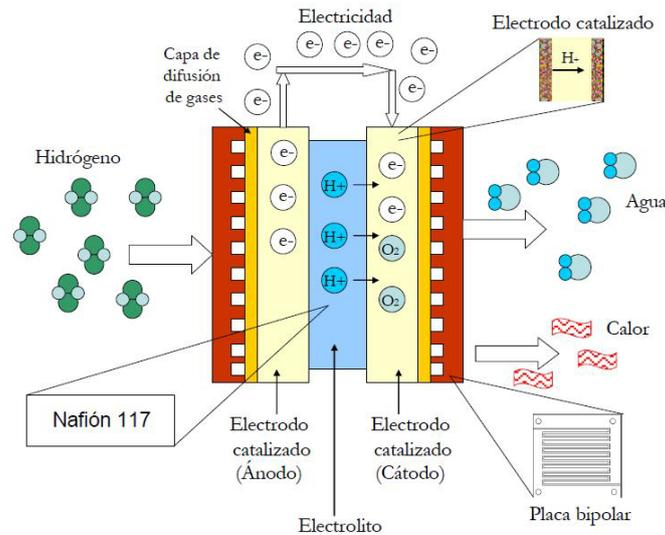
**Figura 1.1.** Esquema general de funcionamiento de una pila PEM. Se pueden observar los diferentes elementos que intervienen en la reacción electroquímica, así como los componentes básicos de la estructura (electrodos, electrolito, placas bipolares y membrana difusora).
