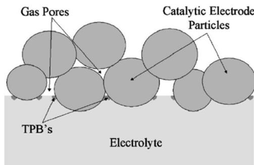
**Figura 1.3.** Esquema simplificado de la interfase electrodo/electrolito en una pila de combustible, mostrando las zonas de reacción electroquímicamente activas (TPB) donde se produce el contacto catalizador-electrolito-gas [O'HAYRE 2005].
