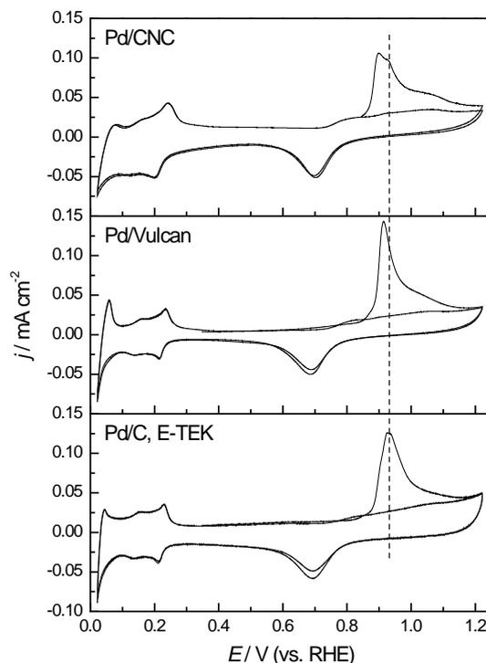
**Figura 3.13.** Voltagramas de oxidación de CO obtenidos para los electrocatalizadores Pd/CNC, Pd/Vulcan y Pd/C de E-TEK en 0.5 M  $H_2SO_4$ .  $E_{ad} = 0.056$  V;  $v = 0.020$  V  $s^{-1}$ ;  $T = 25$  °C.
