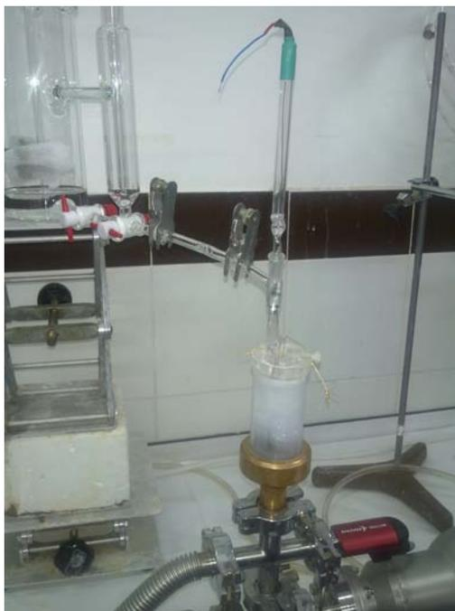
**Figura 2.4.** *Fotografía de la celda electroquímica utilizada para los experimentos DEMS.*
