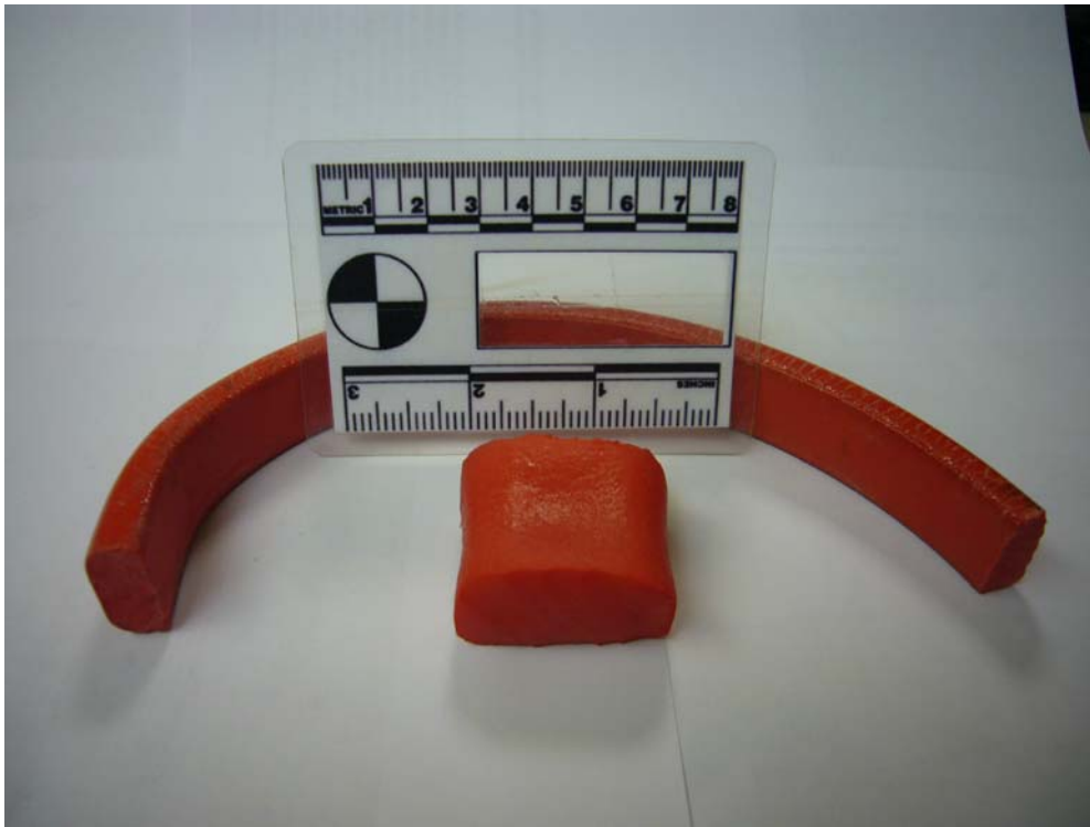
Junta perimetral hidroexpansiva de sellado, seca detrás y húmeda delante.
