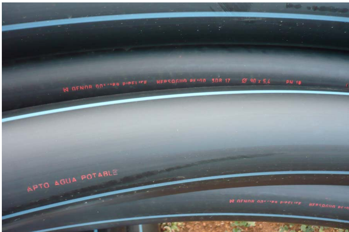
PEAD (PE-100) de Ø 90 mm. y PN 10 Atmósferas.
