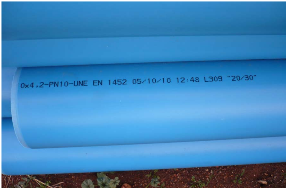
PVC Ø 110 mm. y PN 10 Atmósferas de espiga-campana con junta de goma.
