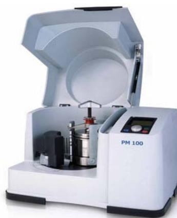
**Figura 12:** Molino planetario de bolas.
