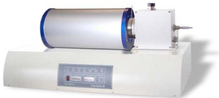
Fig. 24: Dispositivo Linseis SER-3 para medidas termoeléctricas.
