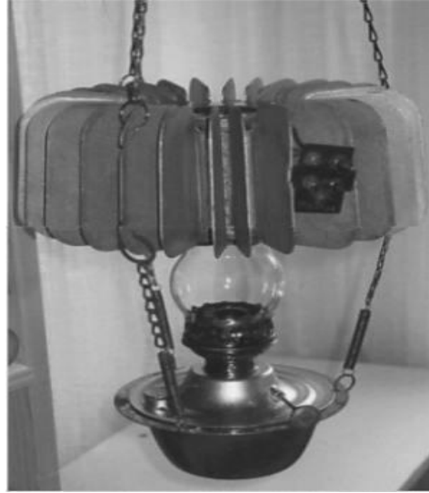
Fig. 9: Generador TE a queroseno para alimentar equipos de radio.
