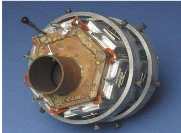
Fig. 10: Prototipo de generador termoeléctrico de BMW, con el conducto central para los gases de escape y los pequeños conductos periféricos para refrigerar el lado frío. Premio ÖkoGlobe 2008.
