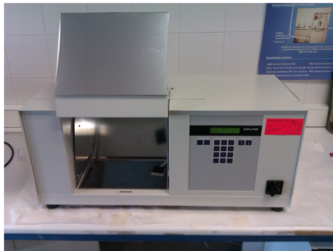
Fig. 5.1. Cámara Solar ATLAS SUNTEST CPS+/XLS+.
