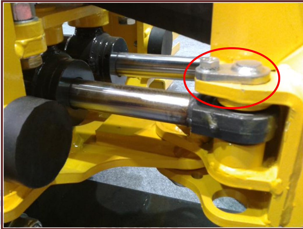
Fig 21. Fijación del eje con chapa soldada más tornillo fijador
