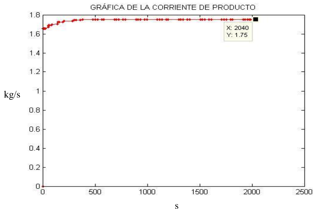
Figura 3.19. Gráfica caudal de producción (kg/s) vs tiempo (s).
