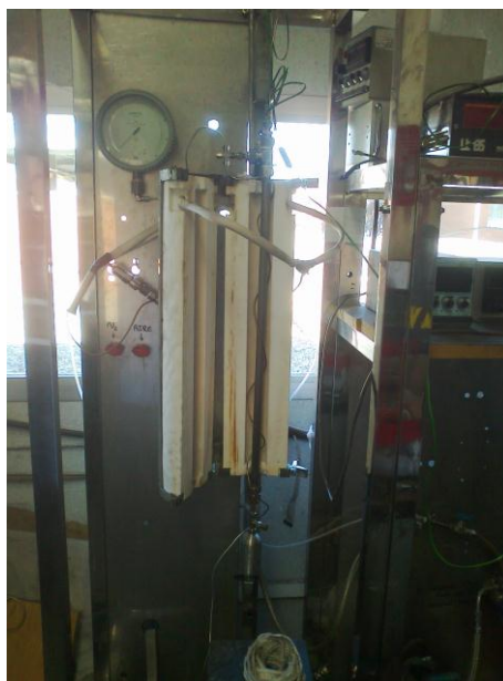
Figura A.10 Instalación de lecho fijo
