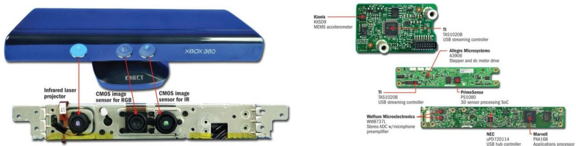
FIGURA 2.9 - Detalle del Microsoft Kinect ( http://www.neoteo.com/como-es-kinect-por-dentro )
