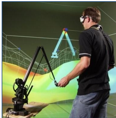
FIGURA 2.1 - Interfaz háptico aplicado a entornos virtuales ( www.neoteo.com/haptics-tocando-lo-virtual )
