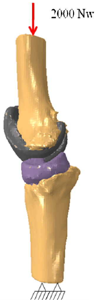
Fig. 3.7 Aplicación vertical de la carga sobre el modelo en extensión completa.
