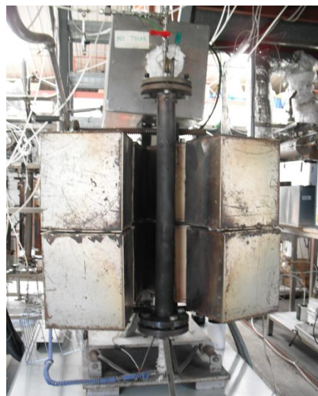
Figura 3.2: Fotografía del reactor con el horno abierto.
