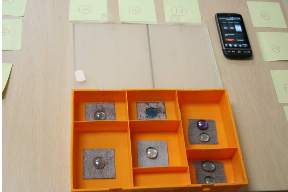
Imagen 29. Se coloca una canica de vidrio sobre las muestras para que éstas estén siempre sumergidas.
