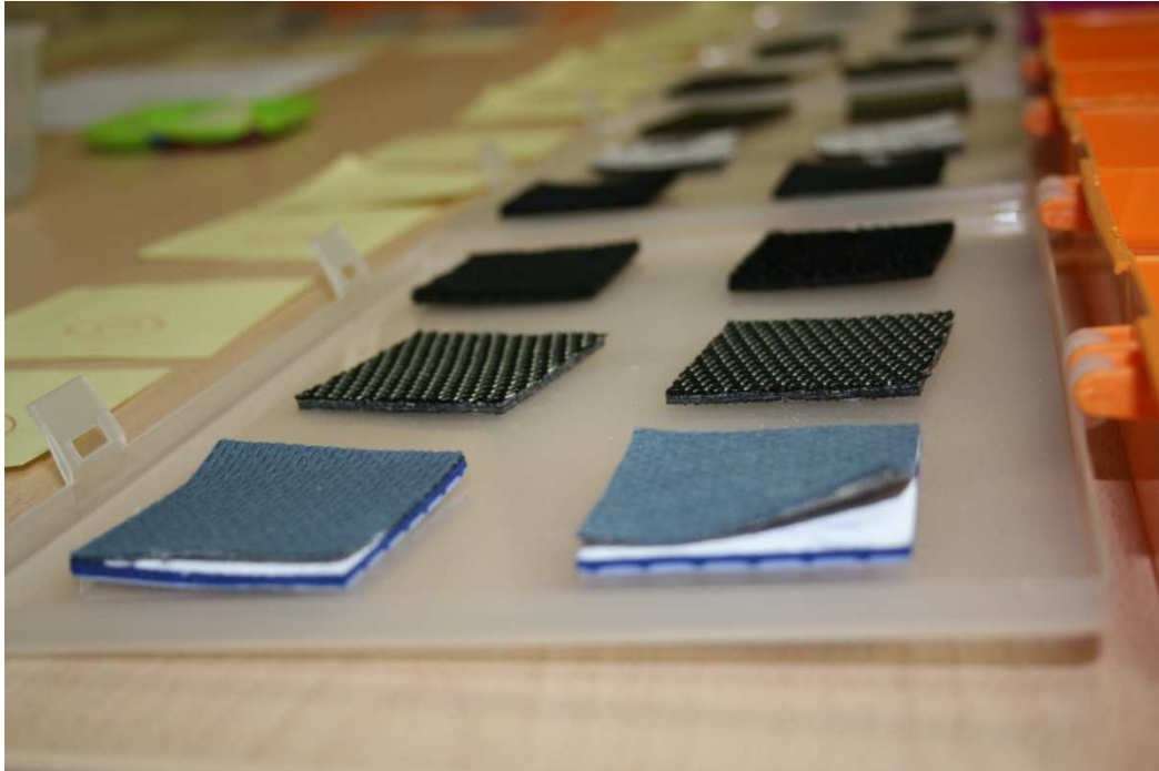
Imagen 30. La muestra de Neutrolor, la primera en la imagen, es la única que sufre desperfectos tras el ensayo.
