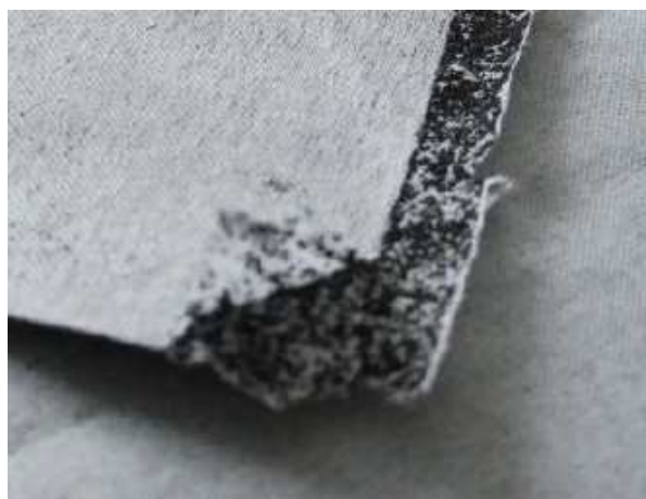
Imagen 20. Lámina de carbón de bambú: polvo de dicho material recubierto por, en este caso, poliéster.
