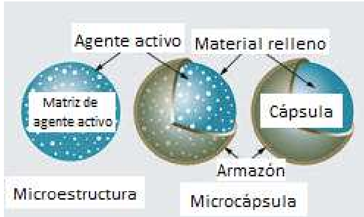
Imagen 16. Estructura de una microcápsula.
