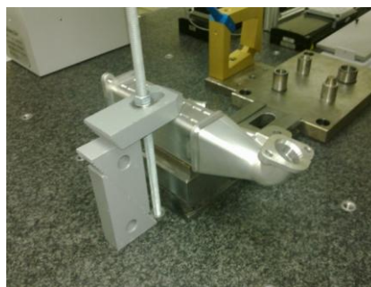
Fig. 2.4 Utillaje requerido para la medición de los modelos de intercambiadores de calor con la MMC.
