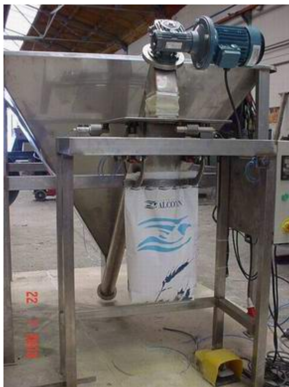
FIGURA 8. Ensacadora con tolva de alimentación.
