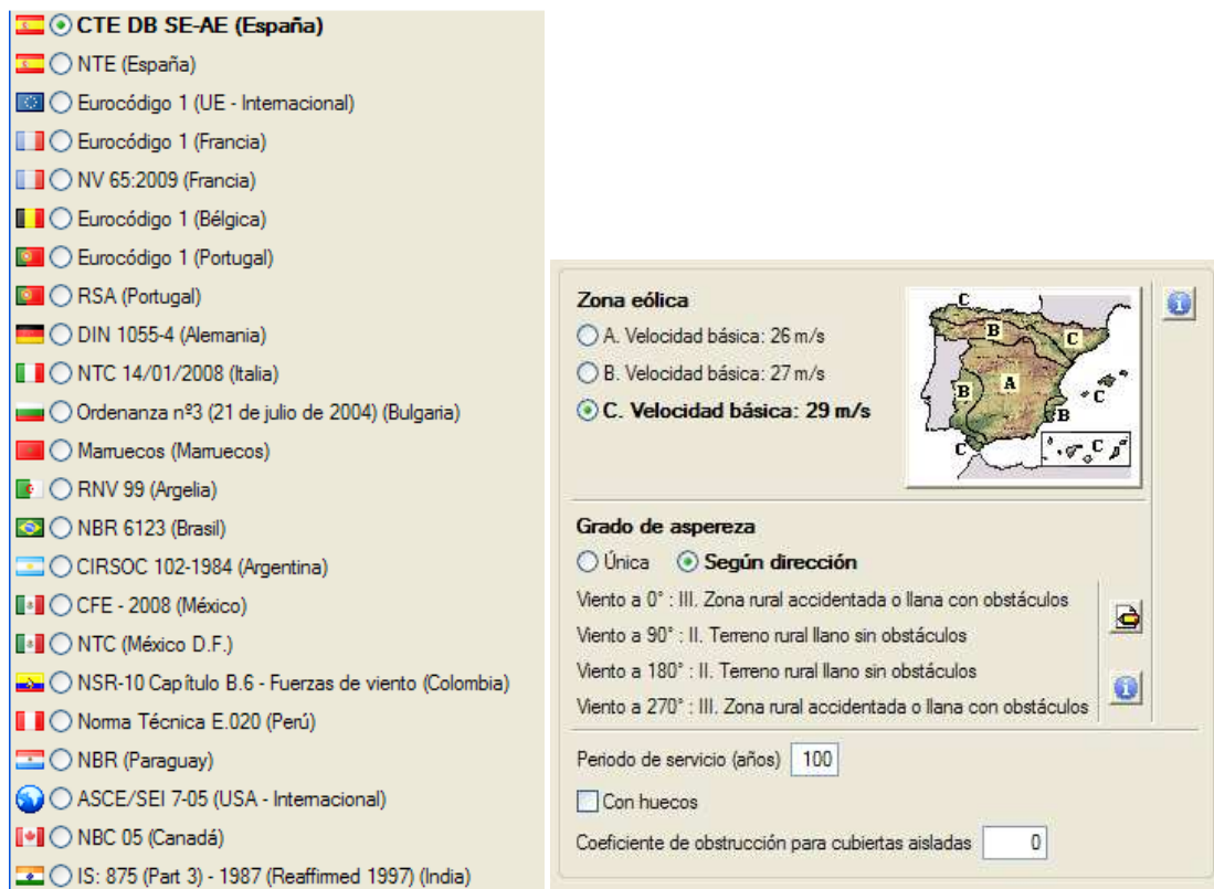
Fig. 2.1.6. Apartados de la ventana Normativa para el cálculo de la sobrecarga del viento, con los parámetros definitivos.
