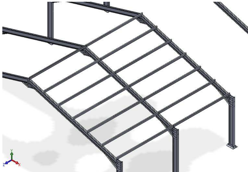
Fig. 3.12.9. Resultado de la matriz lineal de correas en cubierta.
