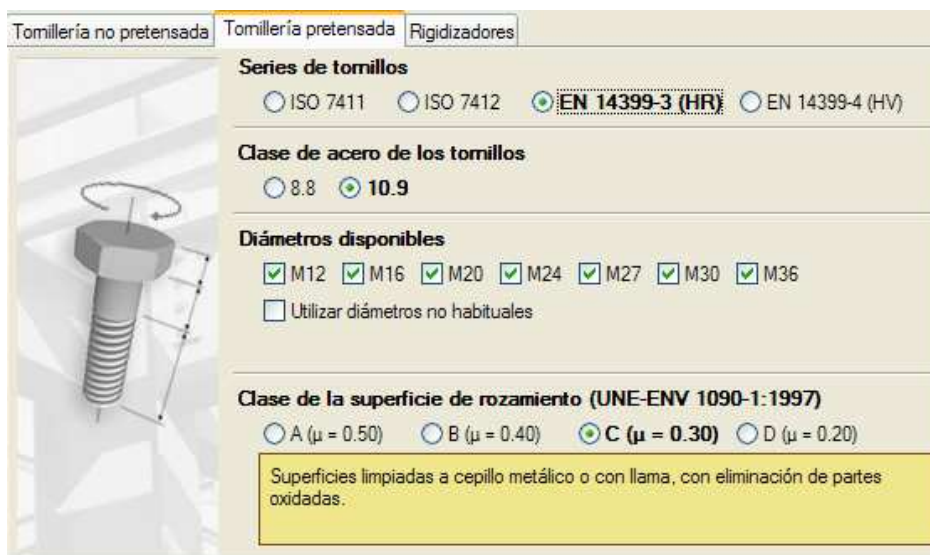
Fig. 2.2.31. Opciones de tornillería pretensada para uniones atornilladas.
