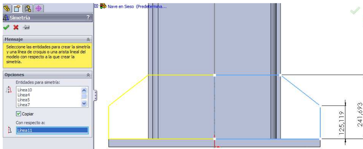
Fig. 3.5.14. Simetría del croquis con las alturas acotadas.
