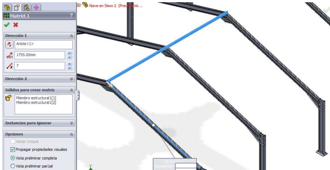
Fig. 3.12.8. Matriz lineal para las correas en cubierta.
