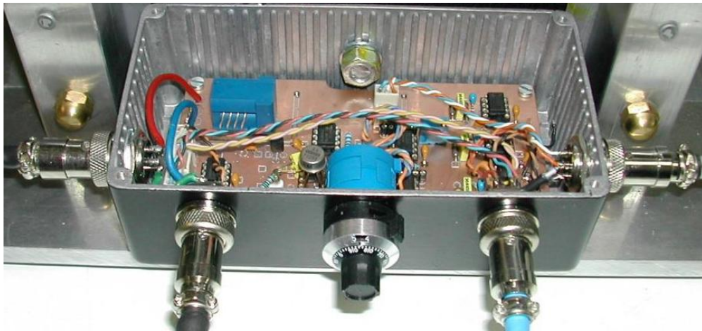
Fig 5.3. Acondicionamiento y Preprocesamiento de las señales del bloque de medida
