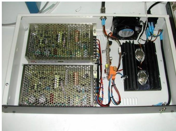
Fig 5.2.: Etapa de potencia mediante dos fuente S-150-27, Meanwell de 150 W que proporcionan \pm 30 V y 5 A.
