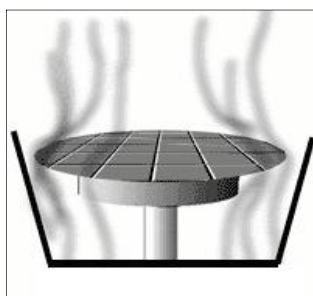
Figura 3. Secado del sustrato recubierto de disolución polimérica [15].
