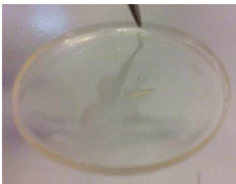
Figura 6.8.2: Ejemplo de membranas obtenidas por el método Casting haciendo uso de placas Petri de vidrio y con 4 ml de volumen de disolución.
