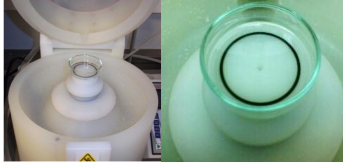
Figura 6.5.1: La placa Petri de vidrio se sitúa en el eje central del spin coater (izquierda) y debe estar bien centrada (derecha).
