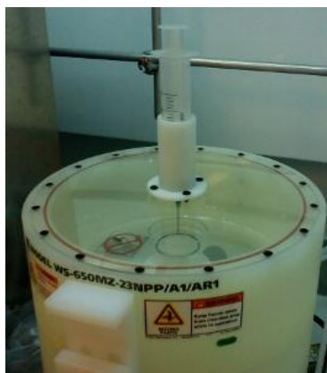
Figura 6.5.4: La jeringa se posiciona en la boquilla superior del Spin Coater que establece contacto con el interior donde está situado el sustrato para la síntesis.
