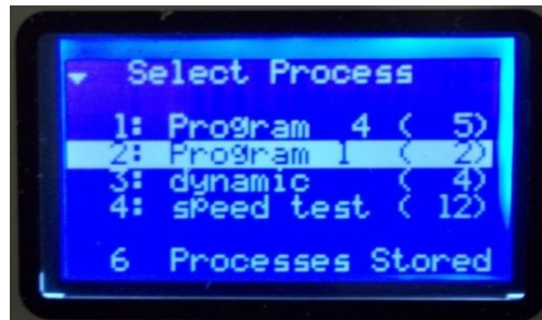
Figura 6.5.2: Pantalla de "Select Process" donde se elige el programa destinado al proceso de síntesis de membranas, que en este caso será el Program 1 (de 2 etapas).
