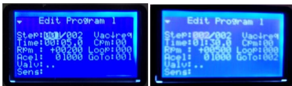
Figura 6.5.3: La etapa 1 "Casting" permanece inalterable durante todo el proceso de síntesis (izquierda) y la etapa 2 correspondiente a la distribución uniforme en el sustrato se varían los parámetros de velocidad (Rpm) y tiempo (Time) (derecha).
