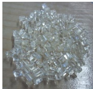
Figura 6.2.1: Pellets o cilindros de la polisulfona comercial Udel P-3500.
