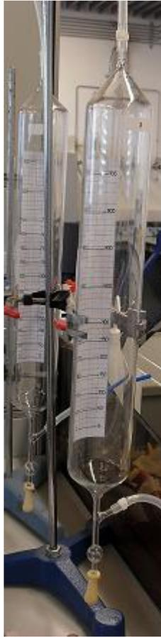
*Figura 2.2. Imagen del burbujímetro utilizado.*
