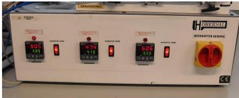
*Figura 2.7. Panel del control de temperatura del horno.*
