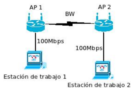
Figura 19: Enlace WiFi entre dos puntos de acceso.
