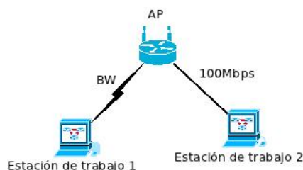
Figura 18: Enlace WiFi entre una estación de trabajo y un punto de acceso.
