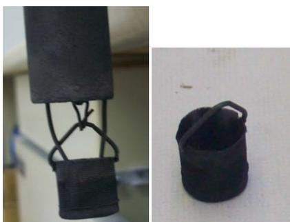
Figura 3.7. Extremo de la parte móvil del reactor con los termopares y la cestilla.
