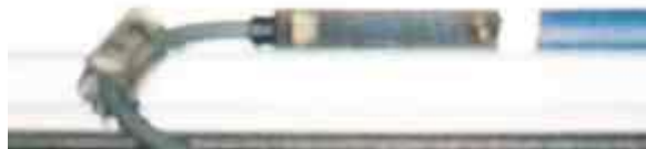
Fig. 212: Interruptor de Proximidad Inductivo
