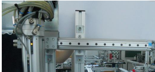
Fig. 181: Actuadores Cinta Avanza / Retrocede
