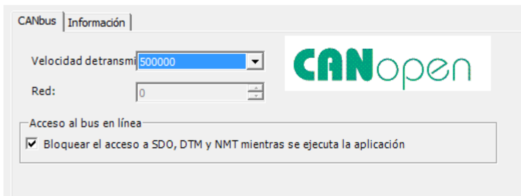
Fig. 228: Establecimiento Velocidad Bus CANopen
