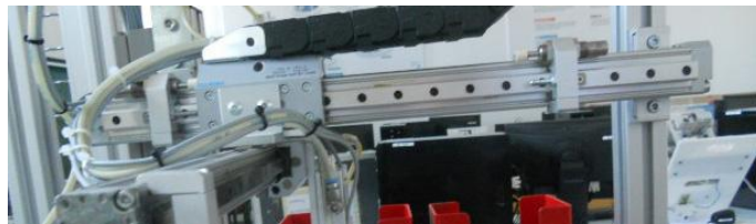
Fig. 218: Actuadores Brazo Izqda / Dcha
