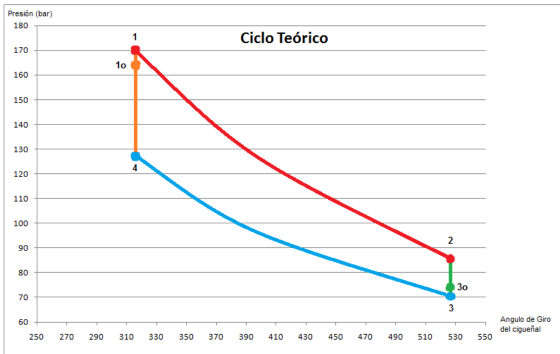
Fig. 40: Diagrama PV Teórico del ciclo del motor Stirling.
