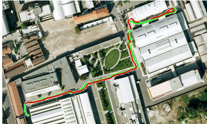
Figura 5.9: Trayectoria GPS (rojo) y trayectoria SLAM (verde) superpuestas sobre la imagen de satélite del Campus de Bovisa (Milán) donde fueron tomadas las secuencias por el equipo de Rawseeds
