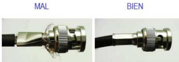
*Figura 22: Colocación cable*
