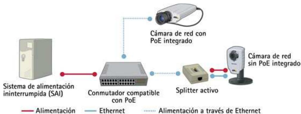
Figura 8: Alimentación a través de Ethernet
