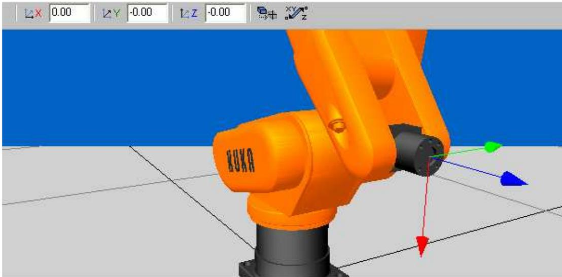
FIGURA 3-67. Tool\_01 en simulador del KR3.
