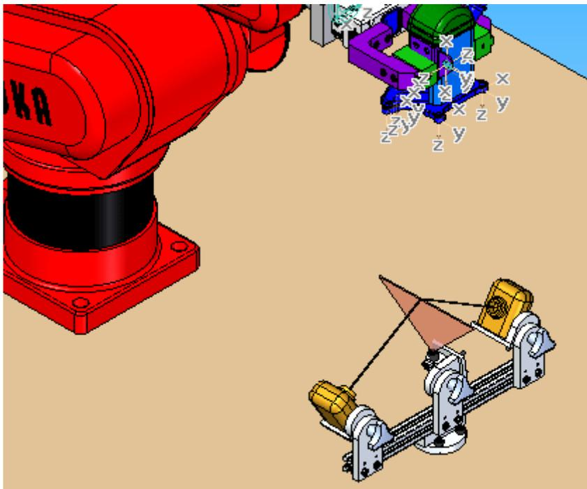
**FIGURA 3-13. Conjunto formado por dos cámaras y un láser situado en la mesa.**
