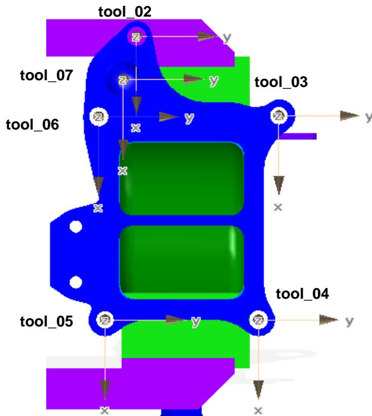
**FIGURA 3-63. Tools en la base de la pieza.**
