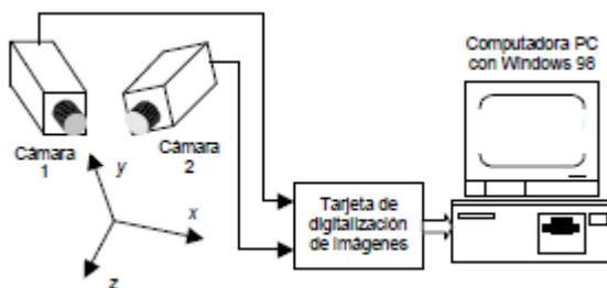
**FIGURA 2-8. Medición con dos cámaras.**
