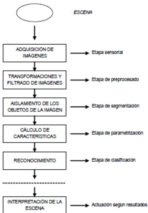
**FIGURA 2-6. Etapas de un sistema de visión artificial.**
