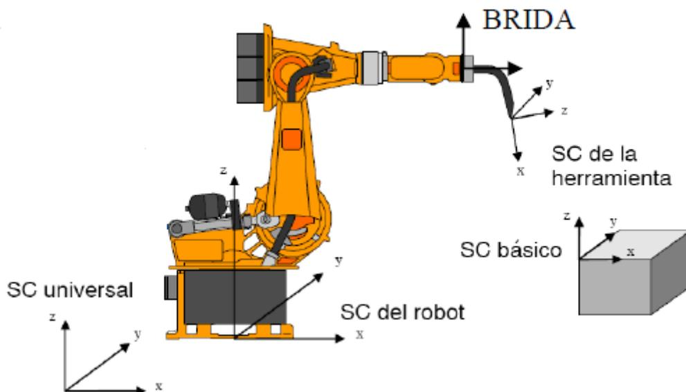
FIGURA 2-5. Sistemas de coordenadas de base y herramienta.
