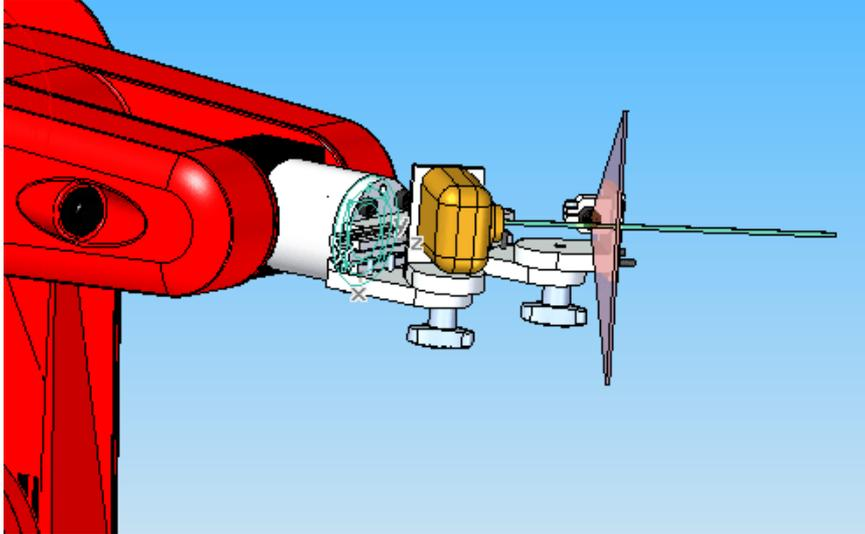
FIGURA 3-16. Conjunto formado por una cámara y un láser situado en la brida del robot.
