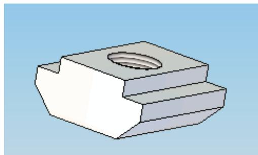
FIGURA 3-36. Unión guía perfil comercial.
