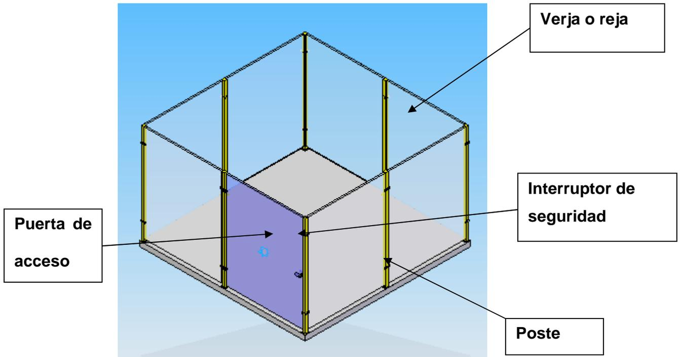
**FIGURA 3-4.** Diseño CAD de la zona de seguridad.
