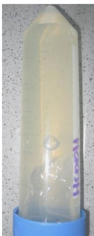
Fig. 5:24: Disolución de cenizas con HCOOH. Textura gel
