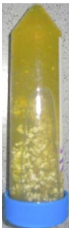
Fig. 5:23: Disolución de cenizas con ácido láctico
