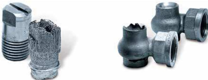
*Figura 4.4: Desgaste de las Boquillas*
