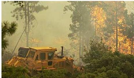
Figura 4.30: Bulldozer creando un cortafuegos y en ataque directo
